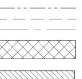
PHASE LINE PROPERTY LINE RIGHT-OF-WAY LINE LOT LINE EASEMENT LINE CENTERLINE TYPE 'B' BUFFER
